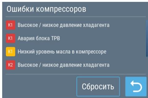
Внутри квадрата указан код узла, например, K1 – узел компрессора 1. Если код узла состоит из буквы и цифры, то буква указывает на название узла, которое приведено в заголовке окна (К – компрессор, В – вентилятор и т.д.), а цифра от 1 до 4 – на номер узла, например, В2 – узел 2 вентилятора (вытяжной вентилятор). Кроме того, часть узлов имеет буквенные обозначения:
