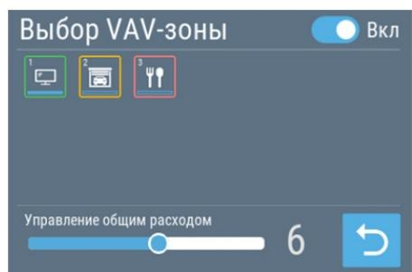
Ползунком «Управление общим расходом» пользователь может снижать поддерживаемое давление, уменьшая, тем самым, общий расход воздуха. Эта функция по умолчанию отключена, поскольку снижение давления может привести к разбалансировке VAV-системы. Разрешить или запретить управление общим расходом можно в сервисных настройках.
