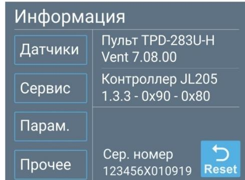
Кнопка «Датчики» открывает экран с показаниями подключенных к вентустановке датчиков температуры и влажности. Для вентустановок с электрическим калорифером снизу отображается полная потребляемая (текущая) мощность вентустановки. Если в системе есть увлажнитель Carel, рядом будет отображаться мощность, потребляемая увлажнителем.
