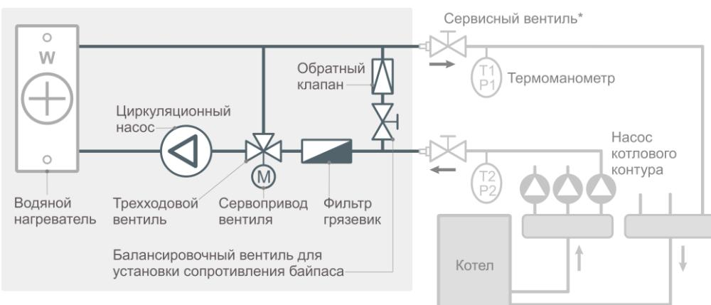
\* Сервисные вентили должны подключаться к смесительному узлу при помощи соединителей типа «американка» для того, чтобы была возможность демонтажа вентустановки.
