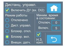
Если режим ДУ отключить (снять галочку **Включить** Д**У**), то вход DI2 переключится для работы с пожарной сигнализацией (при размыкании контакта будет формироваться сообщение Пожар).
